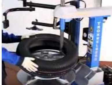
Рис. 10.4. Монтаж шини (внутрішня сторона)
