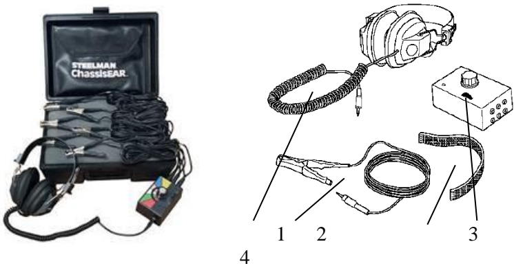
Рис. 2.3. Загальний вигляд підсилювача шумів і стуків: 1 – навушники; 2 – провід із затискачем; 3 – «липучка»; 4 – блок керування;
