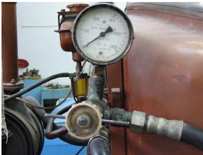
Рис. 7.4. Схема приєднання дроселя-витратоміра КИ-1097 для визначення технічного стану гідророзподільника гідравлічної системи: 1 – прилад КИ-1097; 2 – розподільник; 3 – бак, 4 – насос
