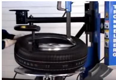
Рис. 10.5. Монтаж шини (зовнішня сторона)
