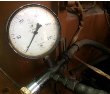
Рис. 7.3. Схема приєднання дроселя-витратоміра КИ-1097 для визначення технічного стану насоса гідравлічної системи:
