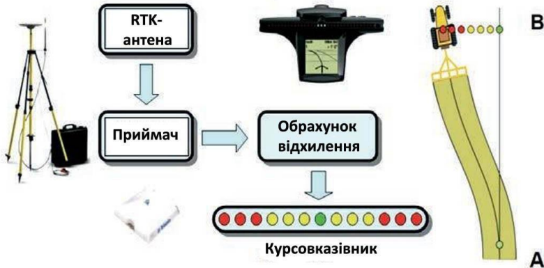
Рис. 1. Принцип функціонування курсовказівника
