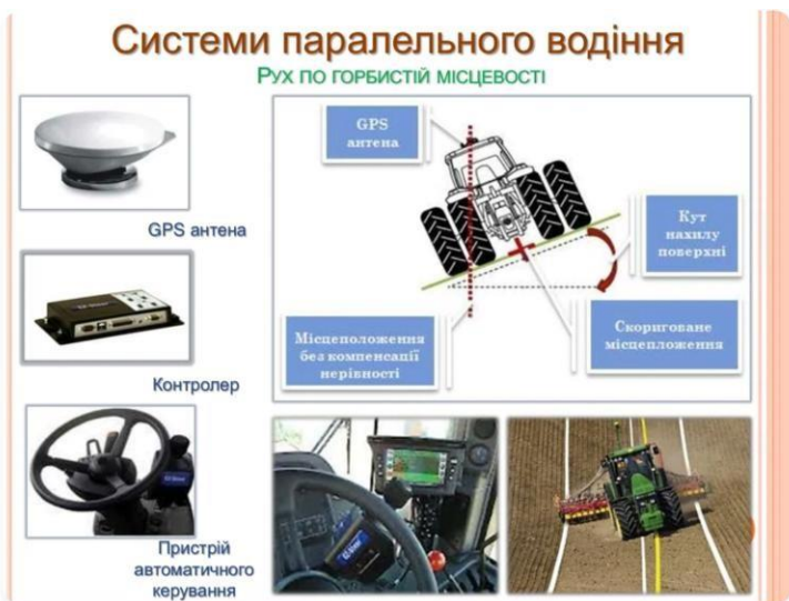
Рис. 2. Типовий склад системи паралельного водіння
