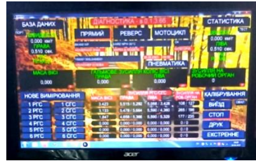
Рис. 3.3. Діагностичний стенд для перевірки гальмівної системи автомобіля
