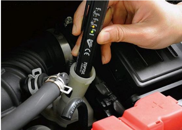
Рис. 3.1. Загальний вигляд індикатора якості гальмівної рідини
