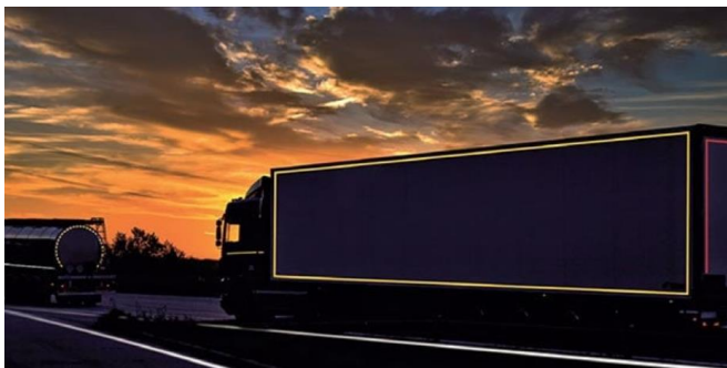
Рис. 5.1. Контурне світловідбиваюче маркування транспортного засобу
