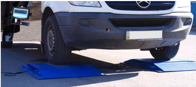
Рис. 6.2. Загальний вигляд підкладних ваг для статичного зважування осей транспортного засобу
