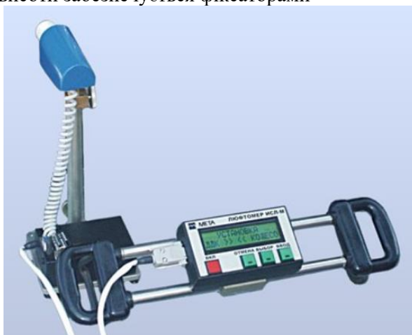
Рис. 2. Загальний вигляд люфтоміра ІСЛ-М (приладовий блок з датчиком руху колеса)
