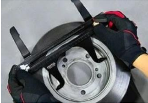
Рис. 3.2. Штангенциркуль для гальмівних дисків і барабанів
