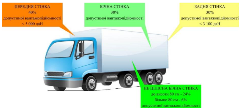
Рис. 1.1. Характеристика елементів міцності кузова вантажного транспортного засобу
