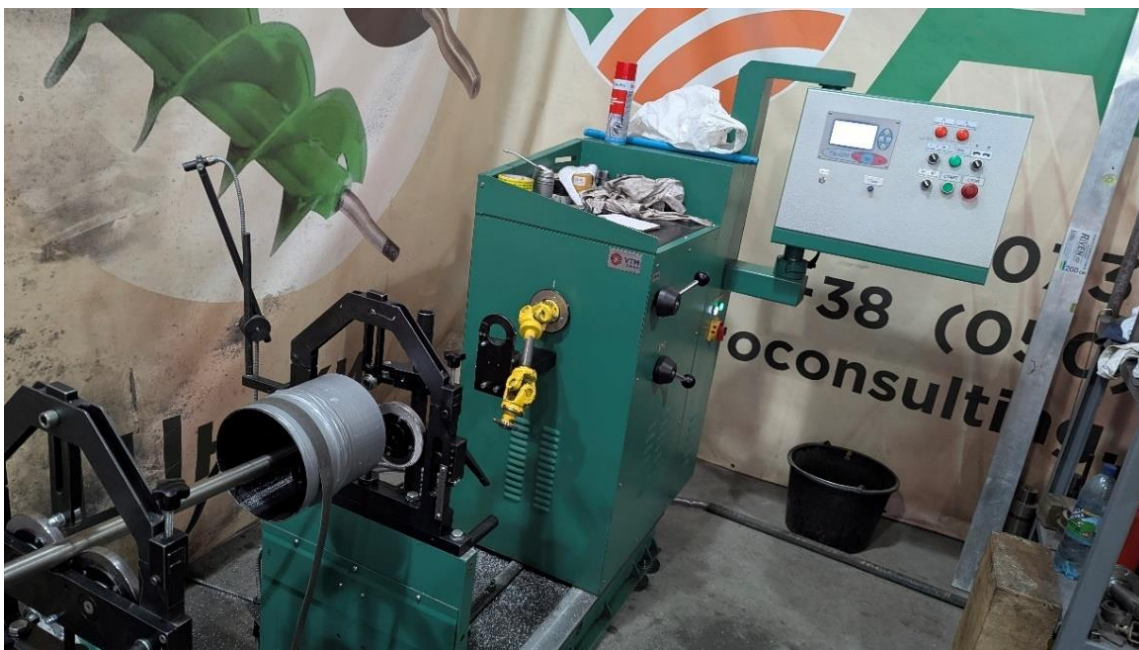
Рис. 3.23. Процес балансування шнекової турбіни на балансувальному верстаті
