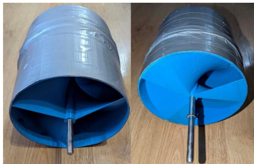
Рис. 3.19. Шнекова турбіна з спіралеподібними лопатями що збільшуються в об'ємі (шифр II 2 )
