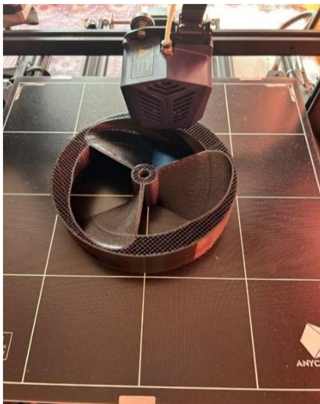
Рис. 3.17. Процес 3D – друку розробленої моделі турбіни на 3D принтері Anycubic Kobra Max
