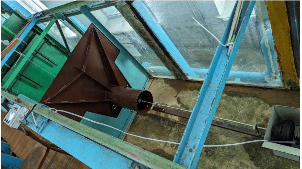
Рис. 3.7. Влаштований в лотік лабораторної установки випробувальний модуль для дослідів у водному потоці (вигляд зі сторони нижнього б'єфа)
