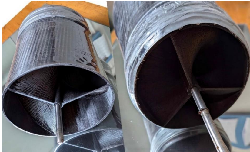
Рис. 3.20. Шнекова турбіна з спіралеподібними лопатями зі звуженням корпусу (шифр III 2 )
