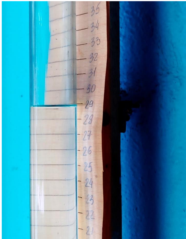
Рис. 3.2. Фото п'єзометра для визначення напору на трикутному водозливі розташованому на напірному баку лабораторної установки
