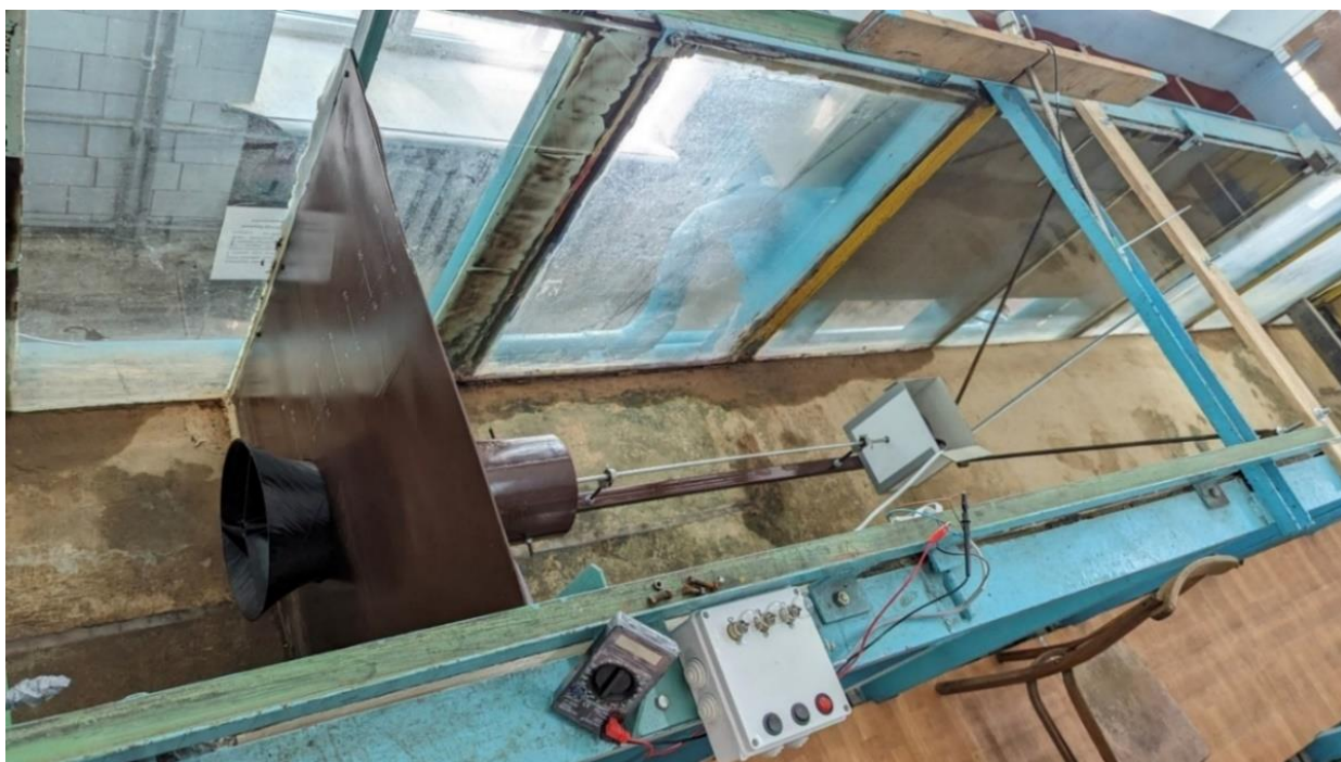
Рис. 3.6. Влаштований в лоток лабораторної установки випробувальний модуль для дослідів у водному потоці (вигляд зі сторони верхнього б'єфа)
