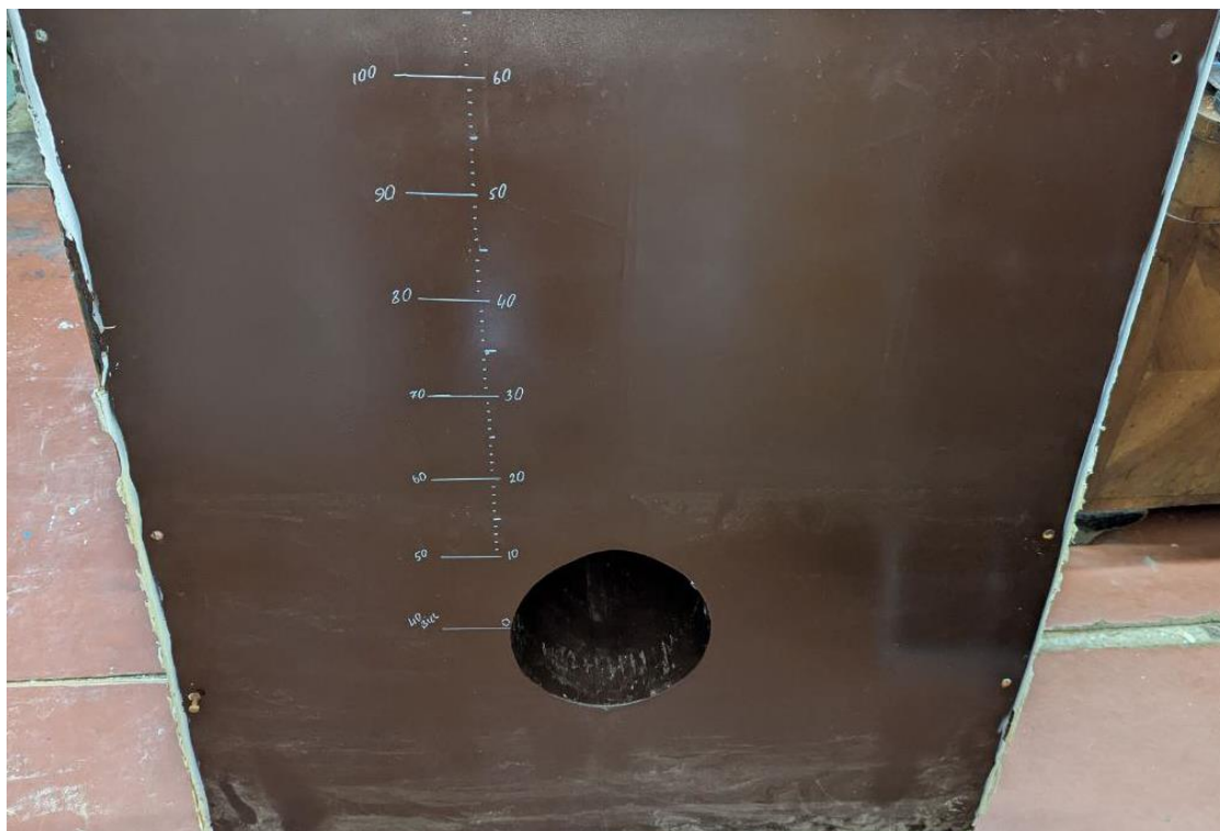
Рис. 3.13. Зовнішній вигляд випробувального модуля з контрольними позначками рівня води у верхньому б'єфі
