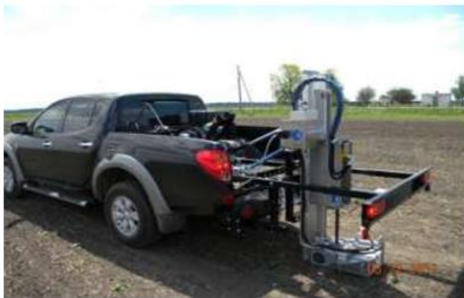
Рис. 1.3. Відбір проб ґрунту автоматичним пробовідбірником
