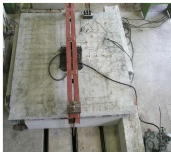
Рис. 1. Схема випробування надколонних плит серії ПН-2:
