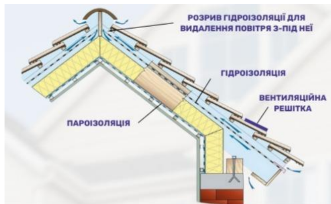
Рис.2. Влаштування вентиляції
