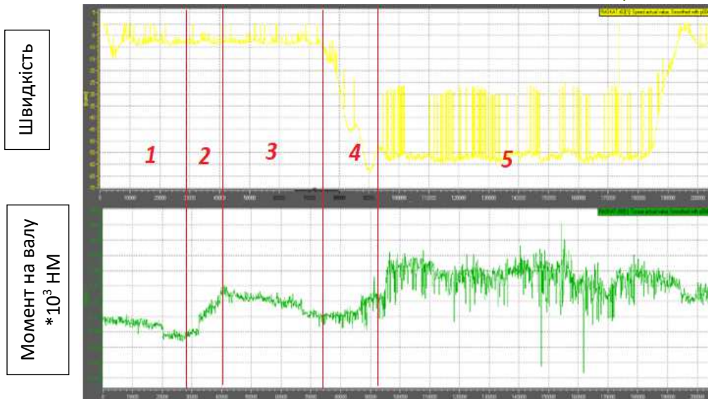
Рис. 9. Графіки параметрів швидкості та моменту на валу приводу розкату системи автоматичного підтримання натягу полотна на повздовжно-різальному стані
