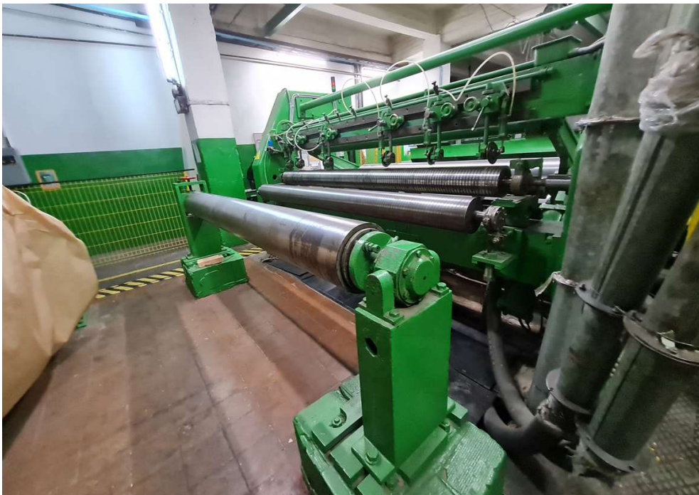
Рис. 8. Фотографії продольно-різального стану. Привід «розкату», привід «накату», вузол ножів
