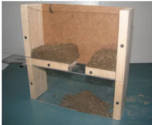
Рисунок. 3.1. Лабораторна установка для визначення кута внутрішнього тертя Досліди проводили в такій послідовності.
