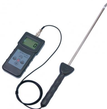
Рис. 2.2. Вологомір PMS710 для вимірювання вологості ґрунту за кондуктометричним методом
