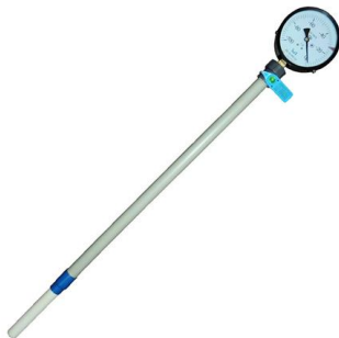
Рис. 2.3. Тензіометр польовий для вимірювання вологості ґрунту за тензіометричним методом
