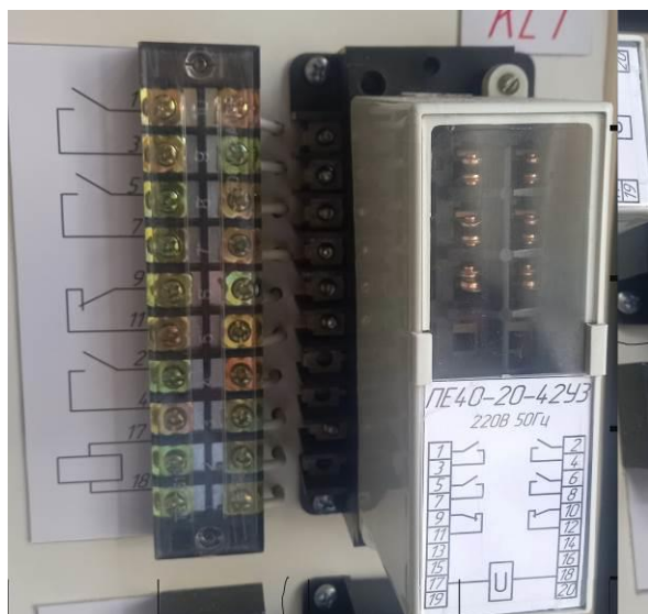
Рисунок 3.9 – Проміжне реле ПЕ40-20-42УЗ
