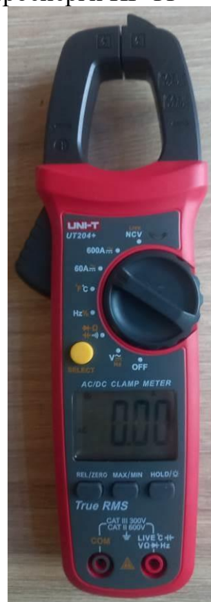
Рисунок 4.8 – Струмові кліщі UT204+.
