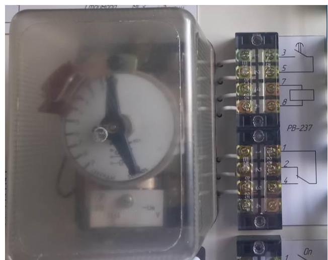
Рисунок 3.8 – Реле часу РВ-237
