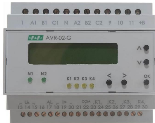
Рисунок 4.2 – Пристрій управління резервним живленням AVR-02-G
