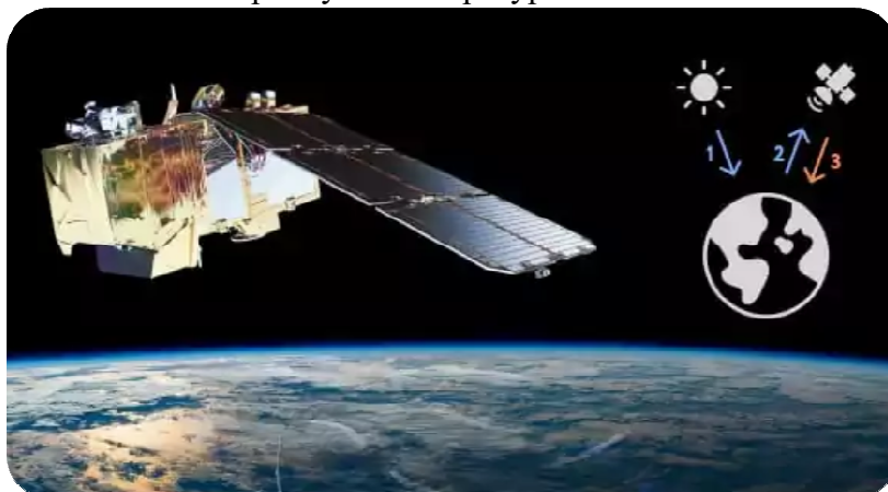
Рис. 2. Принцип пасивного ДЗЗ
