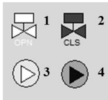
Рис. 2.3. Приклад зображення стану дискретної змінної: 1– клапан відкритий; 2 – клапан закритий; 3 – насос увімкнений; 4 – насос вимкнений
