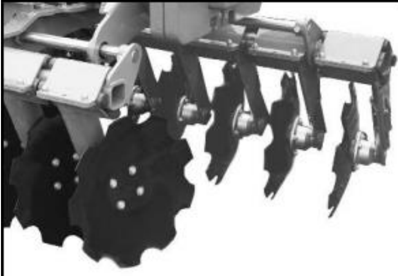
Рис. 4.2. Дискова борона Catros+ з зубчастими дисками і діаметром 510 мм.
