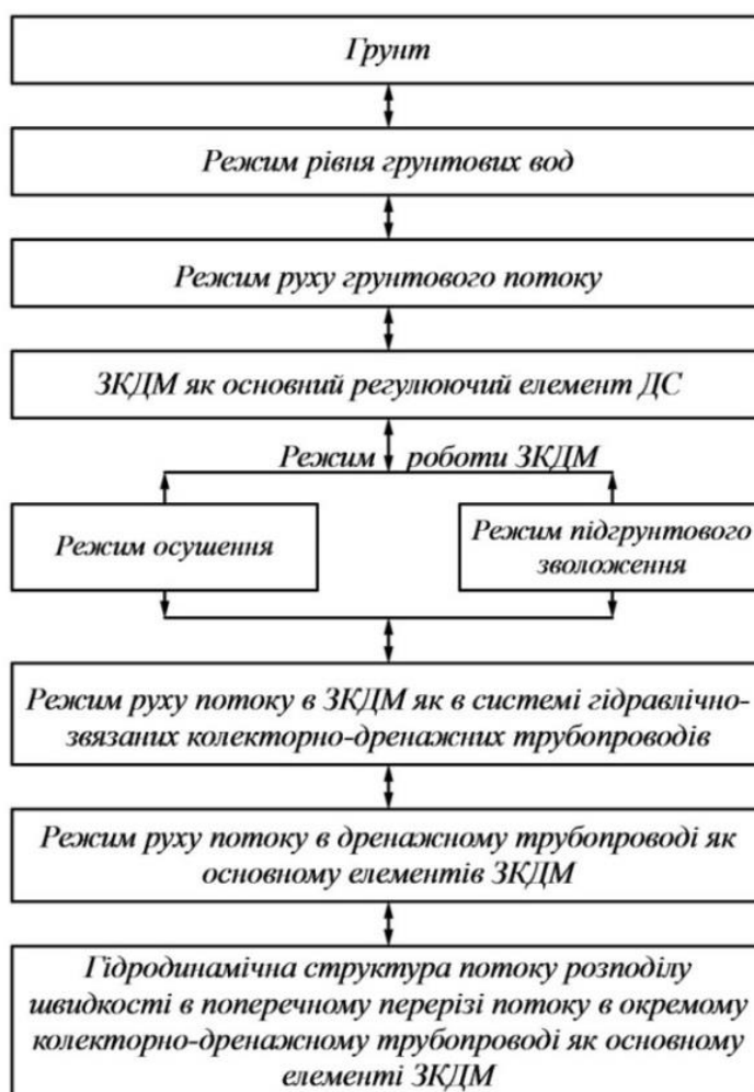
Рис. 3.6. Структурно-логічна схема ієрархічного та гідравлічного взаємозв'язку і впливу режиму роботи ЗКДМ на режим рівня ґрунтових вод меліорованого поля, ефективність чого визначається гідродинамічною структурою розподілу швидкості в поперечному перерізі потоку у дренажному трубопроводі як в окремому елементі регулюючої мережі
