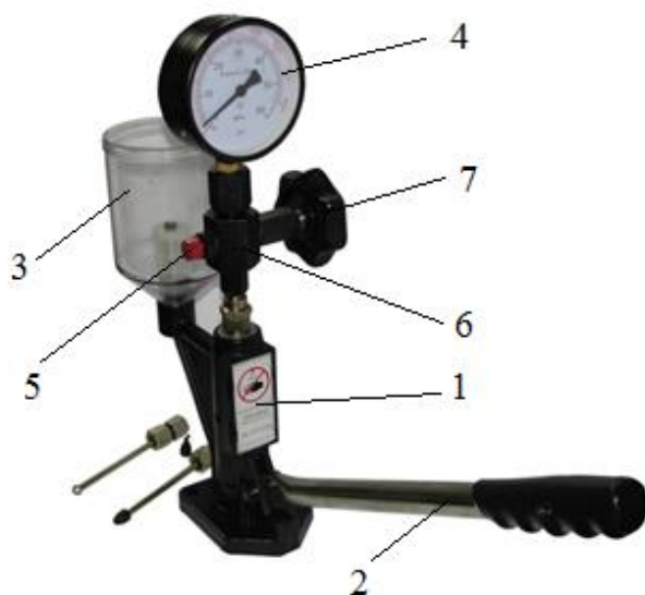
Рис. 5.2. Конструкція тестера дизельних форсунок: 1 – корпус; 2 – привідний важіль ручного насосу високого тиску; 3 – ємність для дизельного палива; 4 – манометр; 5 – штуцер для кріплення досліджуваної форсунки; 6 – розподільник; 7 – вентиль запірного клапана.
