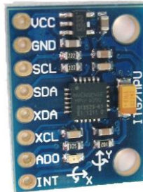
Рис. 3.3. Зовнішній вигляд модуля акселерометра-гіроскопа GY-521
