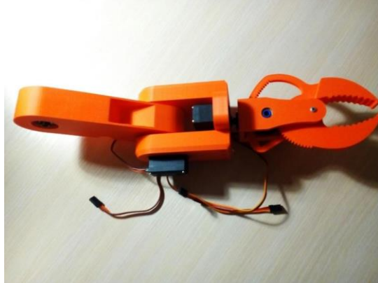
Рис. 5.11. Зона захвату з кріпильними елементами в зібраному стані
