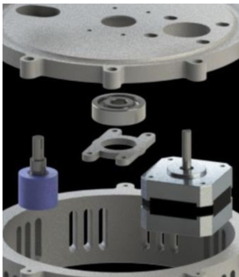
Рис. 5.2. Внутрішні складові активної частини робота-маніпулятора
