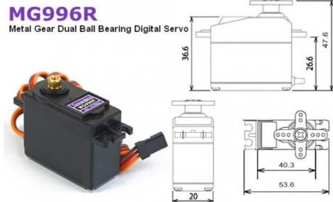
Рис. 6.4. Зовнішній вигляд та розміри сервопривода MG996R
