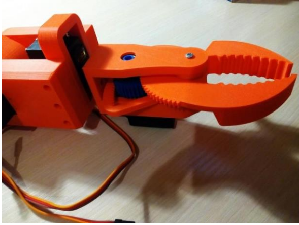
Рис. 5.10. Зона захвату робота-маніпулятора в зібраному стані
