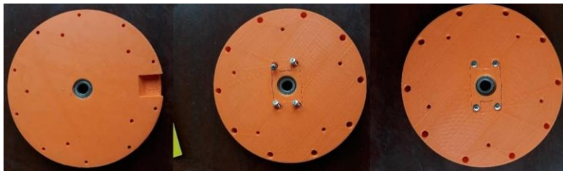
Рис. 5.3. Складові активної частини після друку на 3D-принтері
