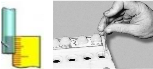
Рис. 5.5. Вимірювання рівня електроліту в акумуляторній батареї скляною трубкою
