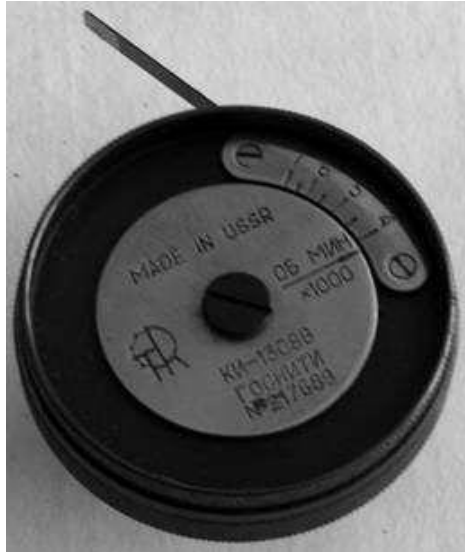
Рис. 2.2.. Прилад КИ-1308В для вимірювання швидкості обертання ротора реактивної масляної центрифуги: 1 – корпус; 2 – установочний гвинт; 3 – кришка; 4 – індекс; 5 – штифт; 6 – гвинт; 7 – ролик; 8 – язичок; 9 – сектор; 10 – шкала.
