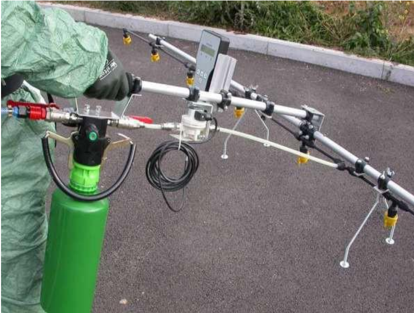
Рис 1.4. Використання електронного витратоміра для постійної витрати робочого розчину.
