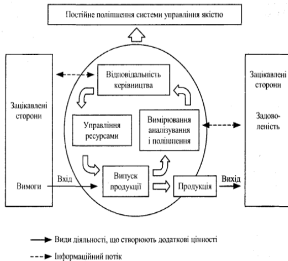
Рис. 7.2. Модель системи управління якістю, що базується на процесному підході
