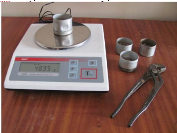
Рисунок 1.3 – Загальний вигляд електронних лабораторних ваг AXIS A500
