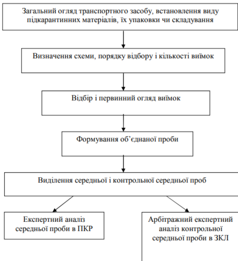
Рис. 2.1 - Схема відбору та аналізу проб підкарантинних матеріалів
