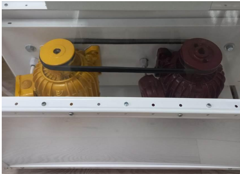
Рисунок 3.7 – Механічне з'єднання асинхронного двигуна та генератора
