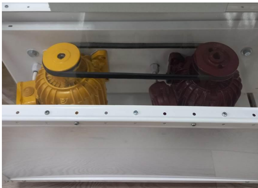
Рисунок 2.5 – Механічне з'єднання асинхронного двигуна та генератора
