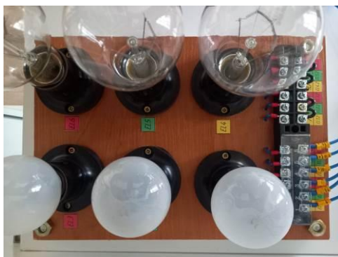
Рисунок 1.2 – Панель ламп розжарювання для створення активного навантаження
