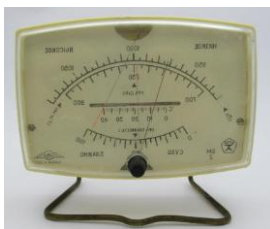
Рис. 2. Прилади для вимірювання вологості повітря: 1 - психрометр ВІТ-1 0-25; 2 – барометр-гігрометр БМ 2; 3 - гігрометр ТФА
