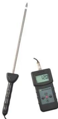
Рис. 9. Вологоміри ґрунту: 1 – Walcom MC-7828SOIL; 2 – Misol WH-0291S-1; 3 – Walcom PMS-710
