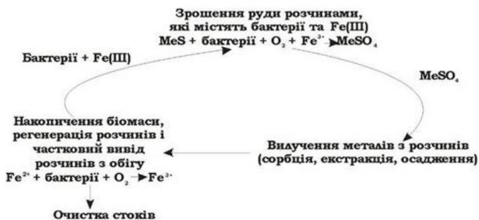
Рис. 2. Схема купного та підземного вилуговування металів із руд
