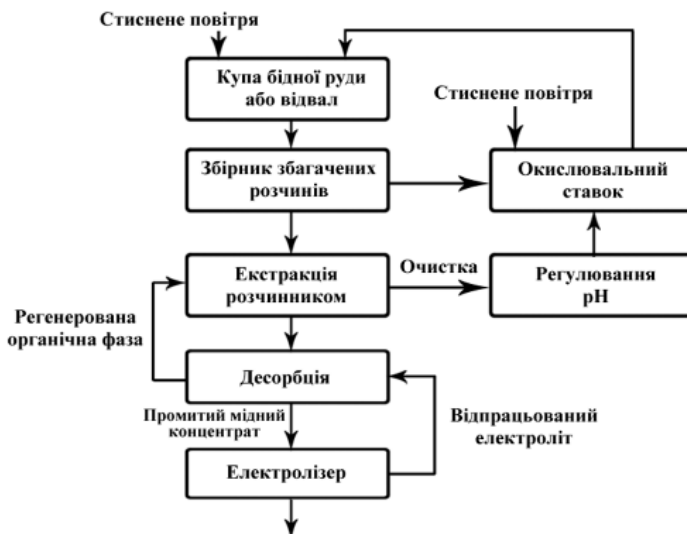
Рис. 4. Схема бактеріального вилугування міді з куп або відвалів руди
