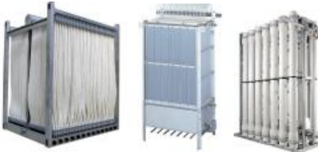
Рис. 19. Типи мембранних модулів: а) порожнисто-волоконні; б) плоскорамні; в) мультитрубні
