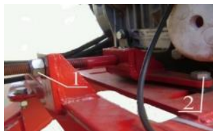
Рис. 5.20 Механізм регулювання натягу пасів приводу вентилятора:
