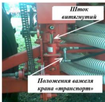
Рис. 5.24 Кран керування приводом у транспортному положенні
