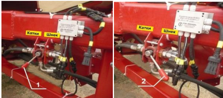
Рис. 5.16 Кран перемикання режимів керування котками і завантажувальним шнеком: положення 1 – робоче (керування котками); положення 2 – завантаження (підключення завантажувального шнека).
