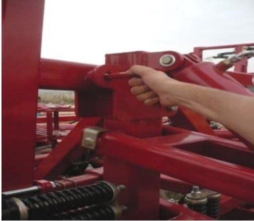
Рис. 5.25 Фіксування секції в транспортному положенні
