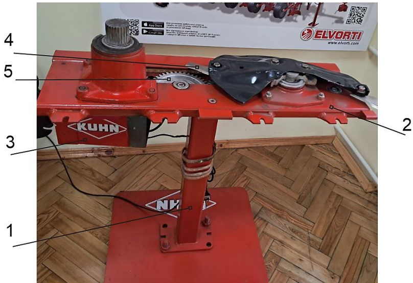
Рис. 8.3 Лабораторна установка з адаптованим для навчальних цілей ріжучим апаратом GMD 10-100: 1. Колона; 2. ріжучий апарат; 3. Електричний мотор-редуктор. 4. Ножі; 5. Зубчасті колеса.
