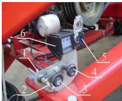
Рис. 5.21 Панель керування двигуном приводу вентилятора.
