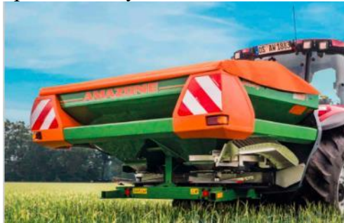
Рис. 1.1 Розподільник добрив AMAZONE ZA-M За допомогою вузької насадки S 500 (рис. 1.2) зберігається мала транспортна ширина.
