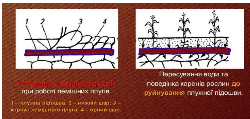
Рис. 1.8 Формування ущільненого шару ґрунту при роботі лемішного плуга
