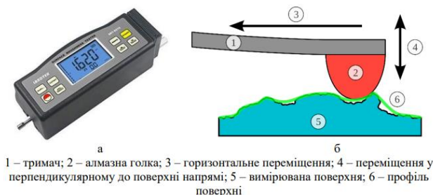
Рис. 5.2 Загальний вигляд (а) і принцип роботи профілометра SRT-6210 контактного типу (б)
