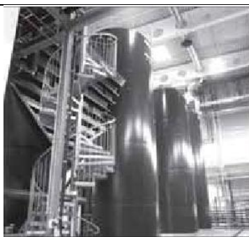
Рис.39. Зовнішній вигляд біоадсорбера безперервної дії із заповненням з коксованого бурого вугілля
