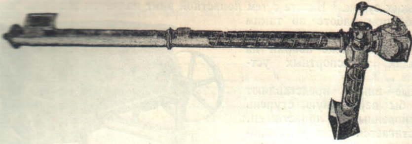
Фиг. 96. Общий вид вертикального шнека (Link-Belt).
