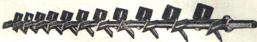
Фиг. 87. Лопастной винт с трубчатым валом (Weller).
