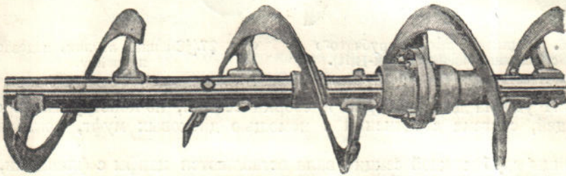
Фиг. 30. Соединение секций сплошного вала ленточного винта с помощью дисковой муфты (Link-Belt).
