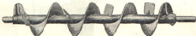
Фиг. 92. Комбинированный винт — полностенный с лопастями (Weller).
