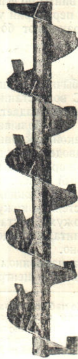
Фиг. 94. Фасонные винты с лопастями и наклепанными угольничками.
