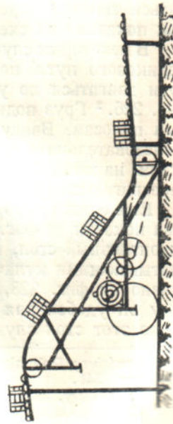
Фиг. 225. Передвижной грузик как компенсатор высоты.
