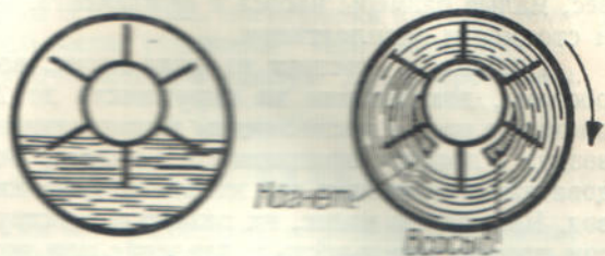
Фиг. 434. Заполнение жидкостью корпуса насоса при покое и при вращении крыльчатого колеса.
