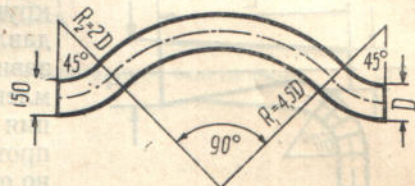
Фиг. 408. Изогнутый участок трубопровода.
