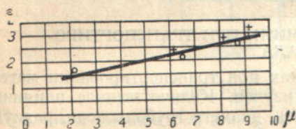
Фиг. 417. Зависимость относительного падения давления \varepsilon от коэффициента смеси \mu для доломитного песка.
