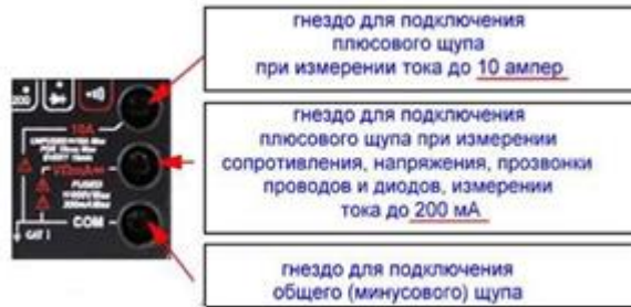
Рисунок 7.2 – Розміщення гнізд для підключення щупів:
