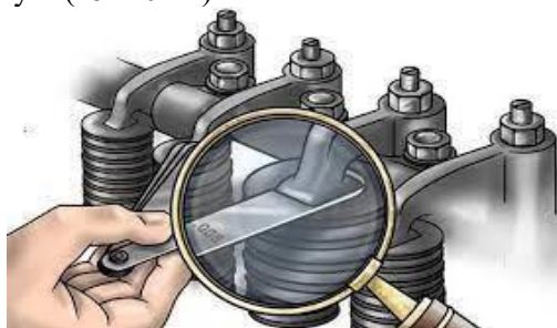
Рисунок 2.1 - Перевірка теплового зазору за допомогою щупа.
