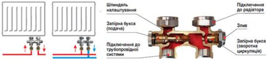
Рис. 1. Влаштування і вигляд клапана HERZ-3000-RL-4 з регульованим байпасом [7]
