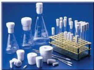
Рис. 3 Лабораторний посуд закритий ватними та паперовими пробками
