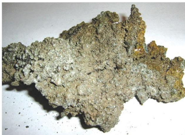
Рис. 1.11 Зола, що спеклася через неправильну зміну палива
