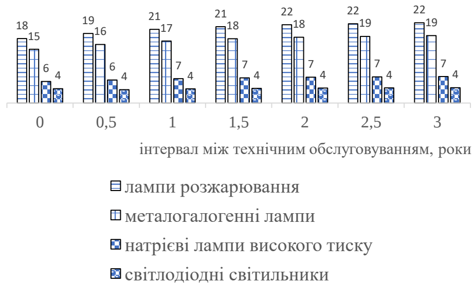
Рис. 3.13. Вплив урахування інтервалу між технічним обслуговуванням світильників на розрахунок кількості ламп для світильників зі ступенем захисту IP5X в забруднених приміщеннях (0 – без урахування технічного обслуговування)
