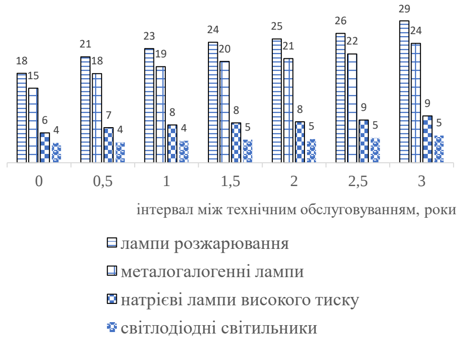
Рис. 3.12. Вплив урахування інтервалу між технічним обслуговуванням світильників на розрахунок кількості ламп для світильників зі ступенем захисту IP2X в забруднених приміщеннях (0 – без урахування технічного обслуговування)
