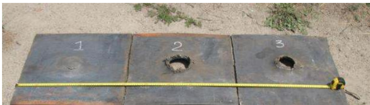
Рис. 2.3. Випробування бризантної дії:
