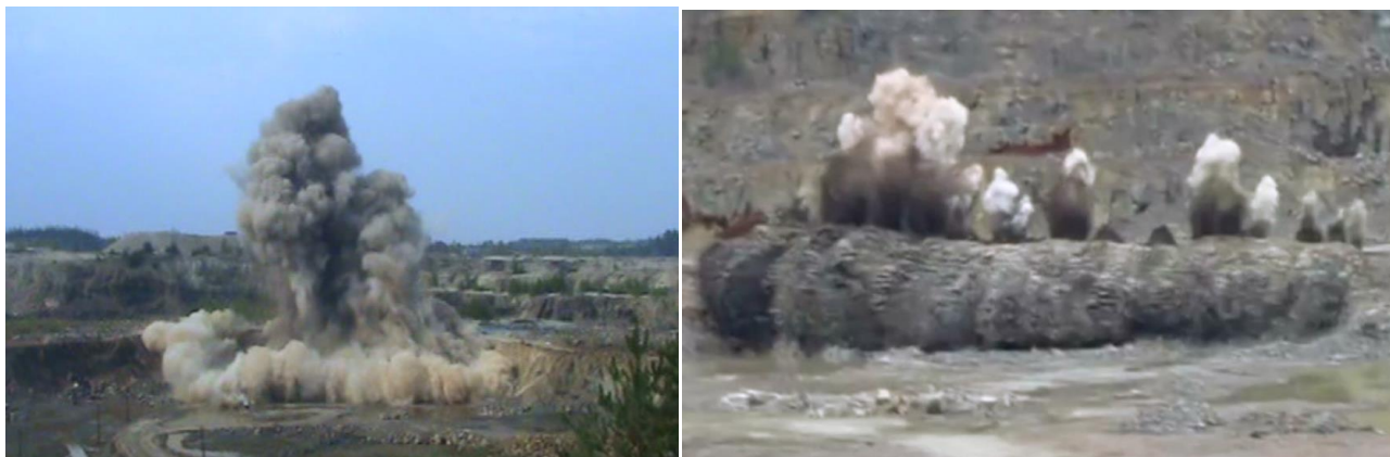
Рис. 2.2. Два промислових вибухи на гранітних кар'єрах: а) – зі значним викидом породи; б) – з незначним викидом породи при хорошій бризантності (стоп-кадри з навчальних відеороликів платформи Moodle навчальної дисципліни «Безпека вибухових робіт» НУВГП)
