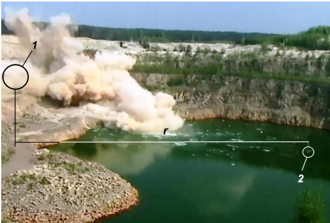
Рис. 2.7. Вибух на кар'єрі з видобування граніту: 1 – центр вибуху; 2 – сплеск на місці падіння шматка граніту; r – радіус розкидання уламків [9]
