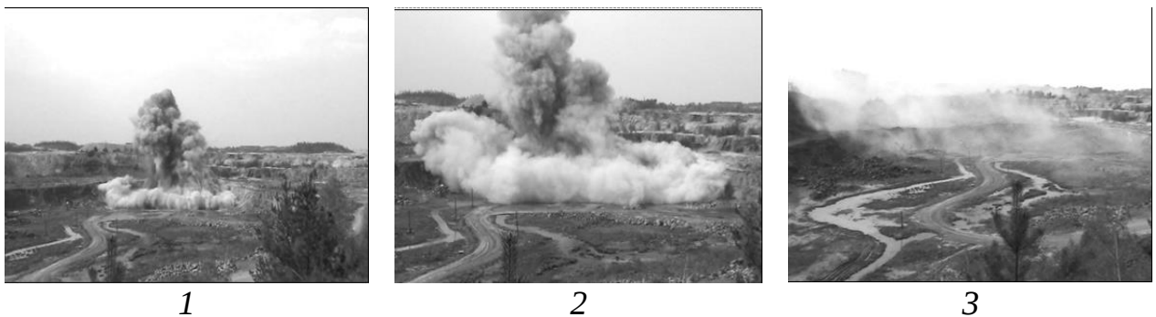
Рис. 3.3. Утворення (1), рух (2) і розсіювання (3) ПГХ в кар'єрі (часовий інтервал між фото 1 і фото 2 – близько 5 хв.) [10]
