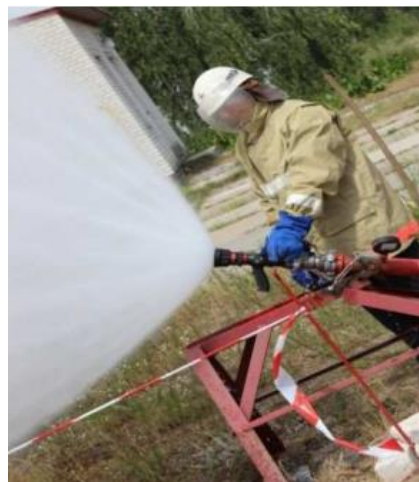
Рис. 6.3. Загальний вигляд розпиленого струменя води з пожежного ствола Protek-366
