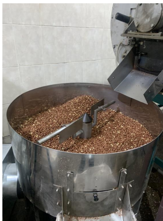
Рис.3. Барабан (охолоджує і збирає шулуху)
