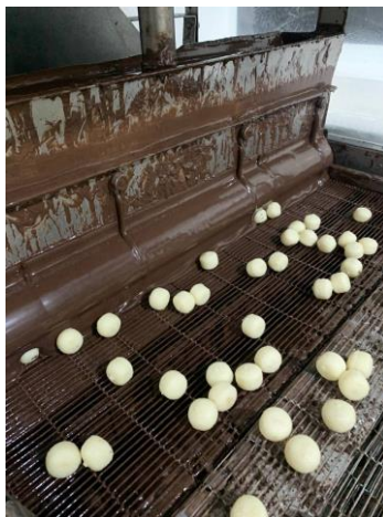
Рис. 1.4. Процес обливання глазур'ю цукерки
