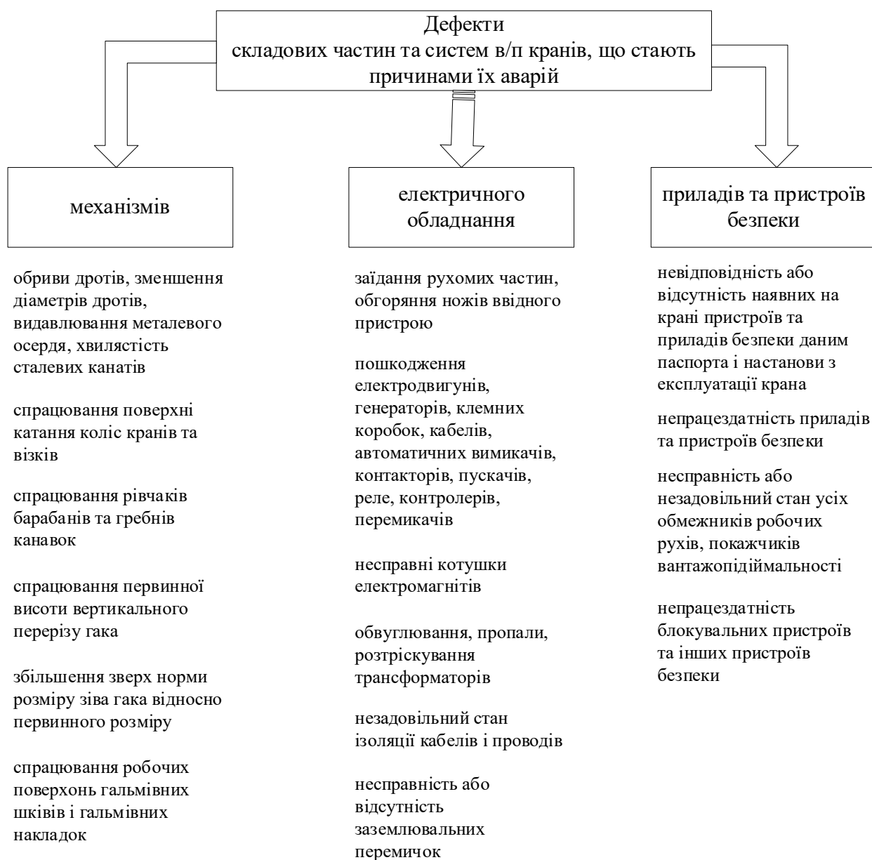
Рис. 1.5. Дефекти вантажопідіймальних кранів, що стають причинами їх аварій
