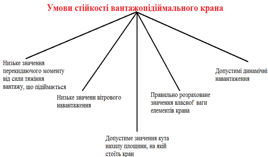
Рис. 1.6. Умови стійкості вантажопідіймального крана
