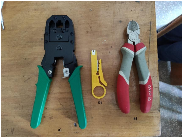
Рис. 1.5. Інструмент для опресування роземів типу RJ-45 (а) – обжимні кліщі (кримпер); б) – спеціальний інструмент для очищення кабелю від зовнішньої ізоляції; в) – бокорізи).
