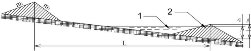
Рис. 5. Схема горизонтальних валів-терас: 1 – ставочок; 2 – вал; L – ширина тераси; h_c – висота вала; \Delta h – робоча глибина.
