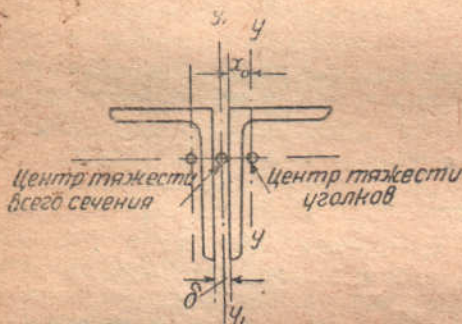
Рис. 180. Сечение из двух уголков 120 \times 80 \times 10 ; момент инерции одного уголка относительно оси yy равен J_{yy} = 99,6 \text{ см}^4 , x_0 = 1,96 \text{ см} , \delta = 1,0 \text{ см} ; площадь одного уголка F = 19,2 \text{ см}^2 .
