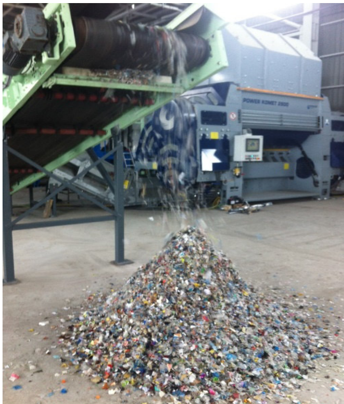
Рис. 3. Зразок матеріалу RDF, виробленого в 2013 році в Україні (м. Рівне)
