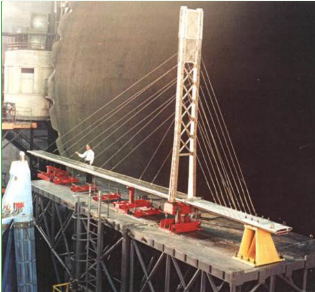
Рис. 10.1. Масштабна модель вантового мосту через Об біля Сургута (масштаб моделі 1/25)
