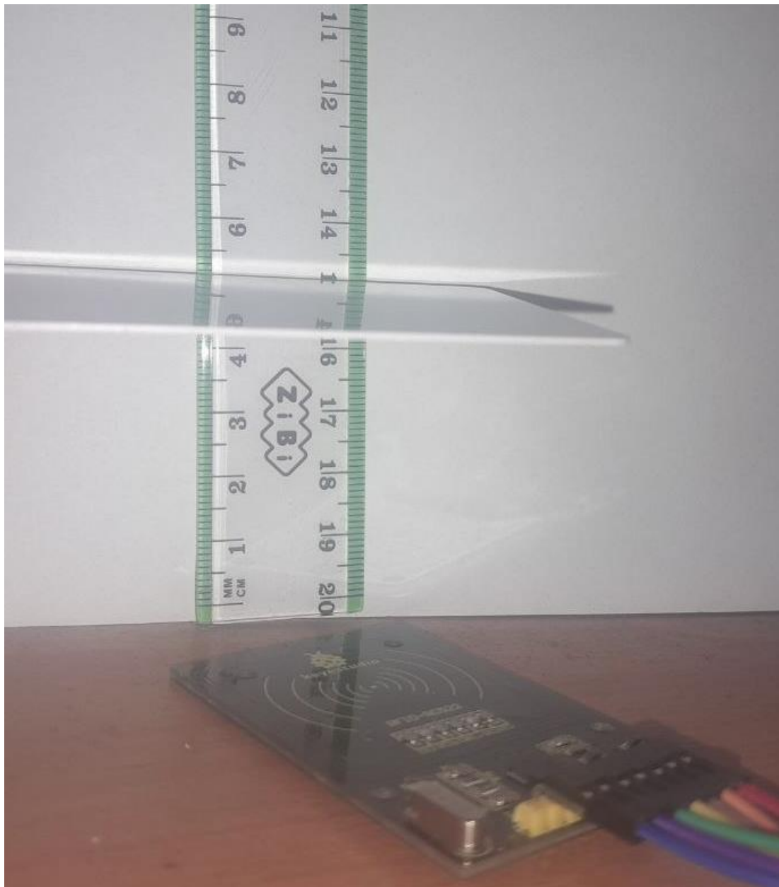
Рис 12. Тестування дальності зчитування картки
