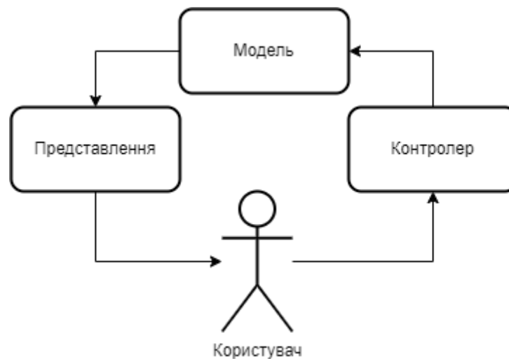
Рис. 2.6. Діаграма MVC патерну.
