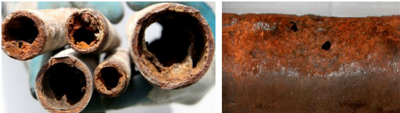
Рис. 1.6. Приклади інкрустації труб продуктами солей жорсткості та руйнування через корозію
