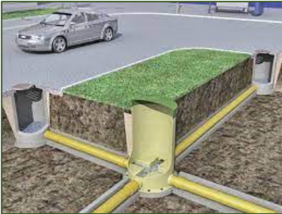
Рис. 3.7. Закриті мережі водовідведення: a) колектор бенкетної форми; б) колектор шатрової форми; в) трубопровідні мережі дощового водовідведення; г) міський простір над закритими мережами
