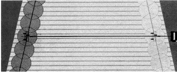
Рис. 10.7. Схема поливу полів різної конфігурації за допомогою штанги AS50 з поворотним пристроєм на 360°
