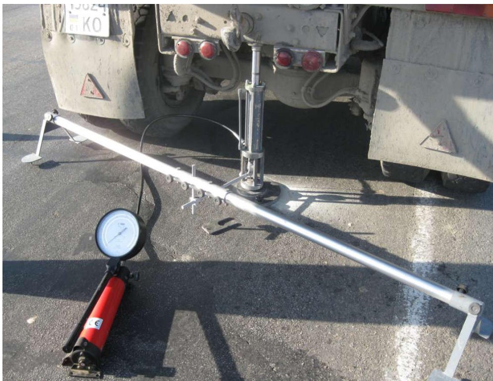
Рис. 3. Загальний вигляд проведення випробувань дорожнього одягу штамповим методом
